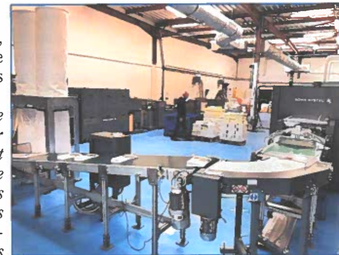
La ligne de production So Simply est composée d'une Canon Océ Jetstream reliée à une chaîne de finition Tecna Libra 800.
